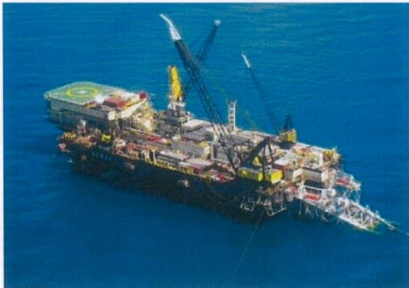
Hình 1.11 Hoạt động lắp đặt tuyến ống ngoài khơi
